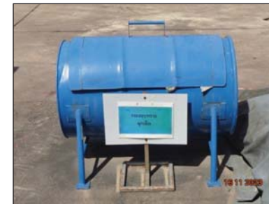
รูปที่ 3.8 ถังทราบดีดดูดซับสารเคมี
